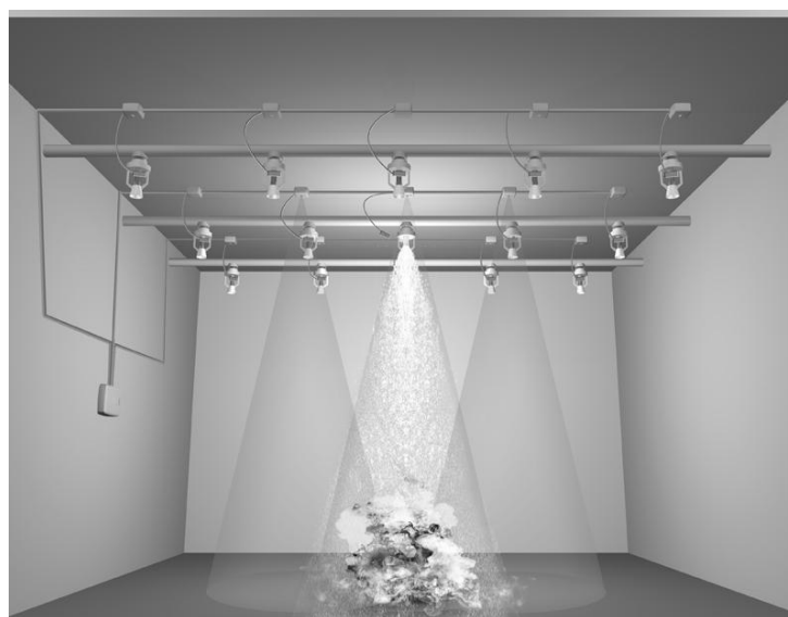
Рисунок 2 – Индивидуальный принудительный пуск спринклера с сателлитным извещателем пламени
