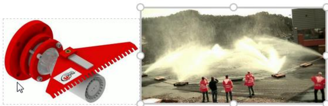
Рисунок 3 – Внешний вид и испытание универсальных водопенных насадков «Антифайер»
