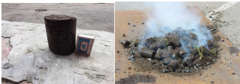
Рисунок 2 – Экспериментальное моделирование источника локального выброса в атмосферу продуктов горения торфа
