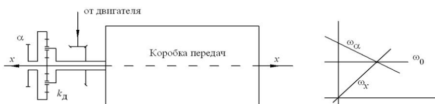
Рисунок 1 – Схема дифференциала привода ветви механизма поворота и вид плана угловых скоростей такого дифференциала
