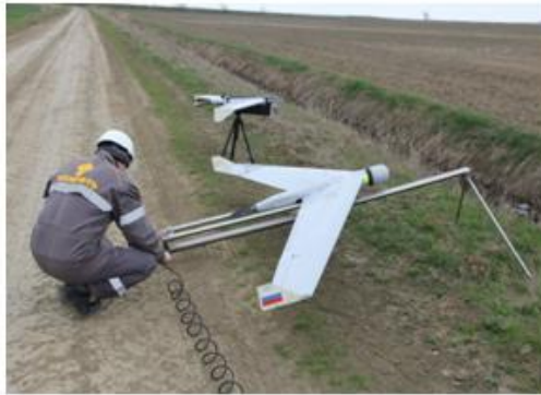
Рисунок 3 – Мониторинг продуктопровода с использованием БПЛА («РН- Краснодар-нефтегаз»)
