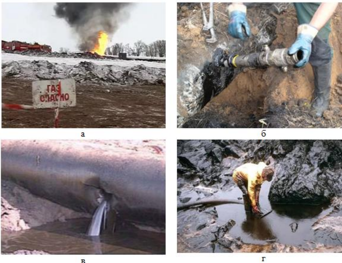
Рисунок 2 – Различные ЧС на продуктопроводах (а – пожар на газопроводе, б – несанкционированная врезка в нефтепровод, в – повреждение трубопровода, г – экологические загрязнение нефтепродуктом)
