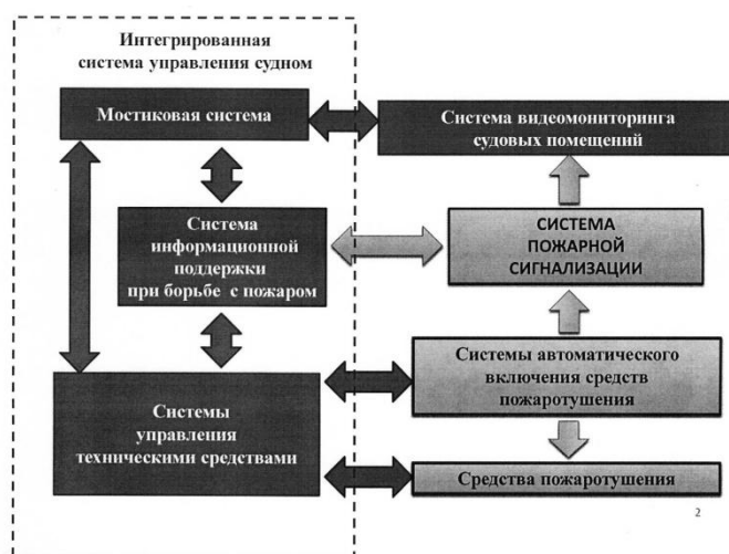
Рисунок 1 – Схема информационных связей системы пожарной сигнализации
