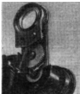
Рис. 59. Совмещение оптических клиньев путем разделения шестеренок
