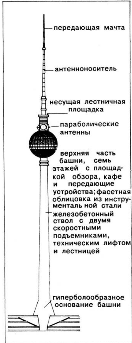
Берлин, телевизионная башня. Строительство 365-метровой башни было завершено в 1969 г. по проекту Х. Хензельманна. 250-метровый ствол несет антенную конструкцию, шар башни диаметром 32 м
